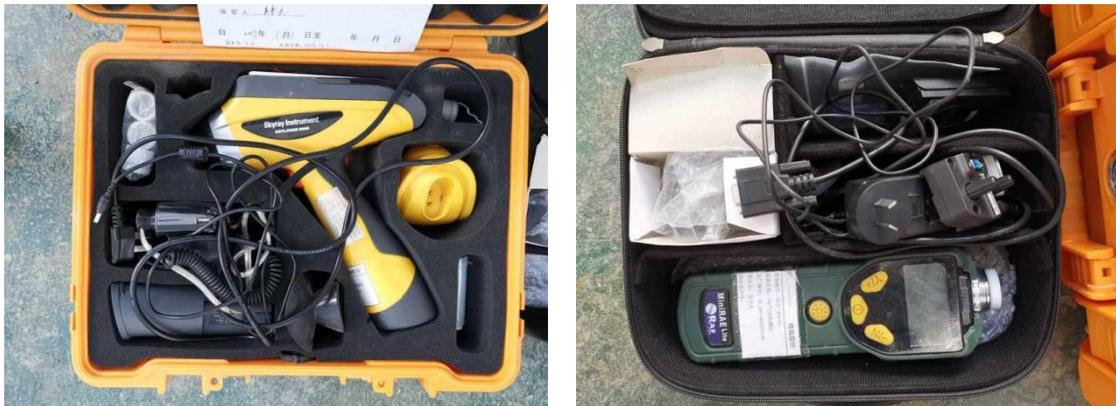
。图 6-2 现场快速检测设备（左边为 XRF,右边为 PID）
